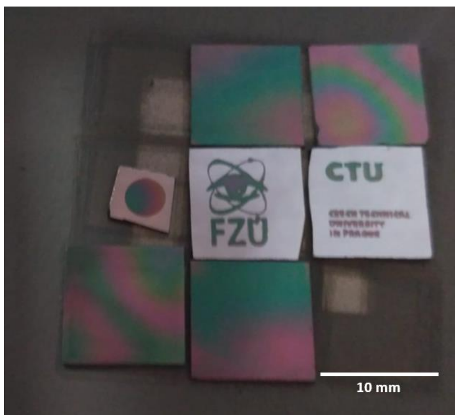
Obr. 14. Fotografie křemíkových substrátů s inkjet tištěnou nukleační vrstvou diamantu a CVD růstu
