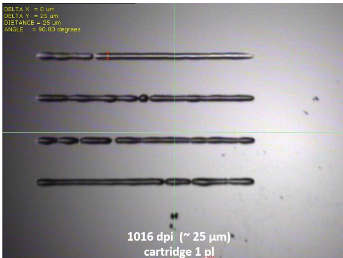
Obr. 10. Seeding čáry vytištěné pomocí 1 pl cartridge
